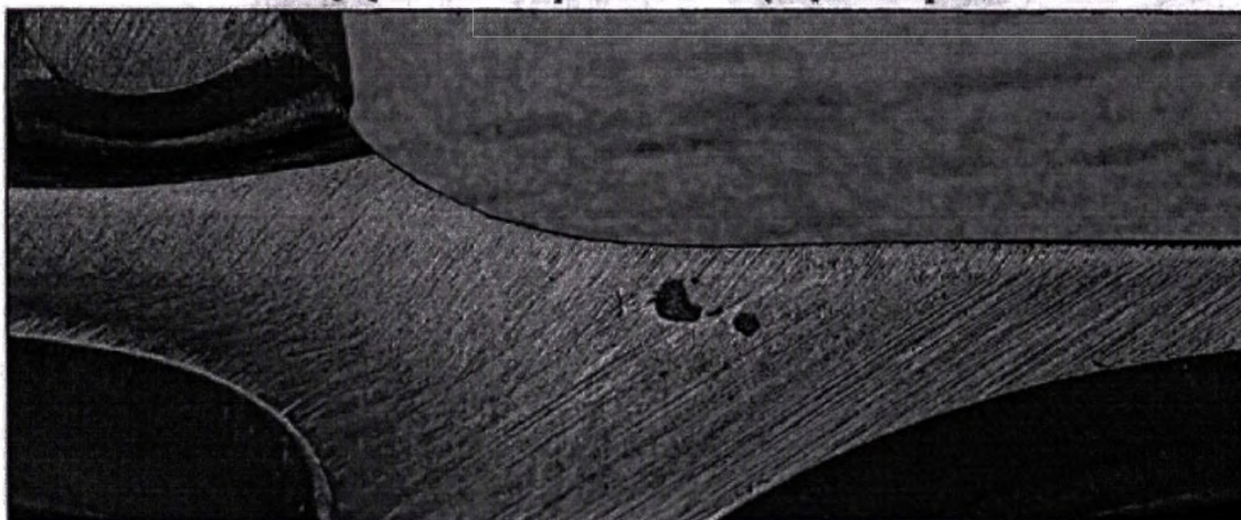
Фотографическое изображение 7 Дефекты поверхностей 1 (крупный план)
